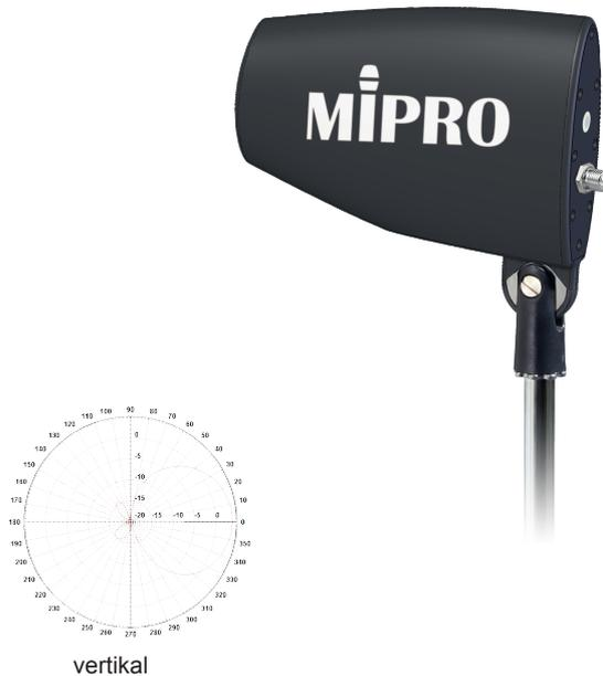
Spezielle aktive Empfangsrichtantenne (5,8 GHz), ist verwendbar für drahtlose Mikrofonsysteme der ACT-5800 Serie. Der eingebaute Verstärker (20 dB  $\pm$ 1 dB) dient zum Ausgleich von Dämpfungsverlusten bei Koaxialkabeln. Die AT-58 kann auf einem Mikrofonstativ befestigt oder mit der integrierten Schwenkadapterhalterung an der Wand befestigt werden. Die AT-58 ist wetterfest und somit auch für den Außeneinsatz geeignet. Für besten Diversity-Empfang wird die Verwendung von zwei AT-58 empfohlen.
