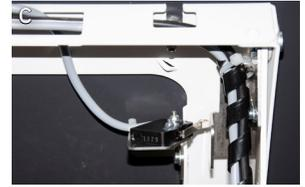
1. Montageort am oberen Befestigungsrahmen in der Ecke ermitteln, wo der Kabel-Spiralschlauch mit dem Projektor-Netzkabel verlegt ist.
