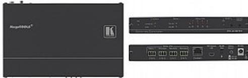
FC24ETH ist ein EthernetSteuer Gateway, das über das EthernetLAN eines Kunden PlugandPlayfähig ist und über bidirektionale serielle RS232 oder RS485Steuerverbindungen Fernbedienungen für kundengesteuerte Geräte ermöglicht. Mehrere Steuerclients können über eine IPVerbindung mit dem FC24ETHSteuer Gateway verbunden sein, um gleichzeitig zwei RS232 oder RS485steuerbare Geräte zu steuern, z.B. AVScaler, Videodisplays und Audioverstärker
