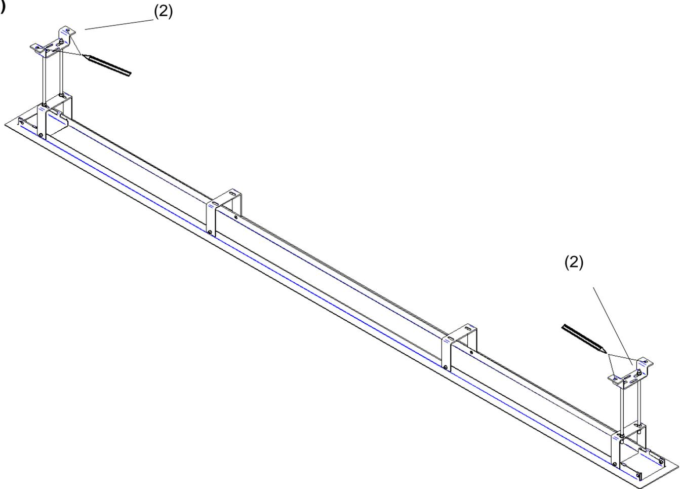
Übertragen Sie das Bohrbild der Deckenhalterung (2) auf die Decke.
