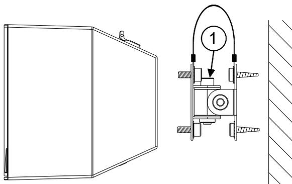
**ANMERKUNG:** Bitte denken Sie daran, den Sicherheitshaken anzubringen, und dass die mit "1" markierte Schraube oben angebracht wird, damit der Kasten auch bei Lockerung nicht aus der Halterung fällt.
