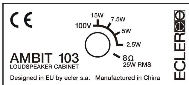
Die AMBIT103 verfügt über 4 Leistungsstufen für deren Anwendung in 100V Linien. Sie können dementsprechend in Ihrer Beschallungsanlage die Lautstärke in den verschiedenen Zonen entscheiden. Wählen Sie entweder 2,5 oder 5W wenn die Zonen geringe Lautstärke haben sollen. Wählen Sie 7,5 oder 15W wenn der Druckpegel hoch sein soll.
