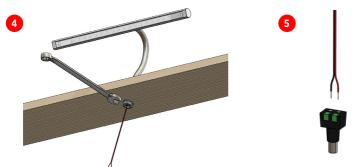
Mutter + Scheibe auf Gewinde aufschrauben und mit Gabelschlüssel (Gr. 17) vorsichtig festdrehen 4. Kabel mit der Lüsterklemme (im Lieferumfang enthalten) verbinden 5.
