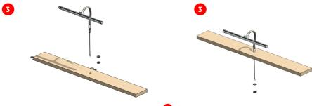
Lampe mit Kabel von oben in die Bohrung führen 3.
