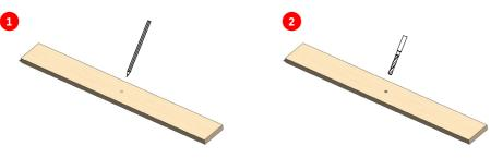
Loch anzeichnen 1 und bohren (Ø 10 mm) 2.
