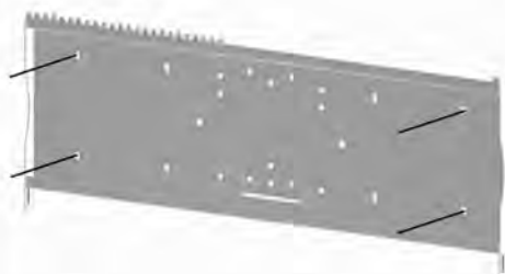
Montage basisplaat aan muur
