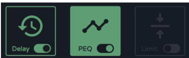
Bearbeitung der Verarbeitungsmodule Hier können die Module zur Visualisierung und Konfiguration der Parameter ausgewählt werden, daneben ist es möglich, das jeweilige Modul schnell zu aktivieren/deaktivieren, ohne auf die Konfigurationsseite zu gehen.
