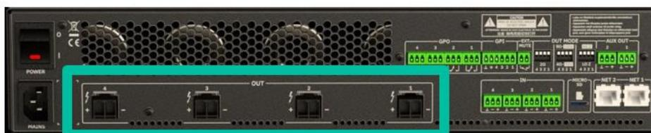
**Achten Sie immer auf die relative Polarität der Ausgänge (+ und – an den jeweiligen Ausgangsanschlüssen) sowie der Verkabelung und der Lautsprecher.**
