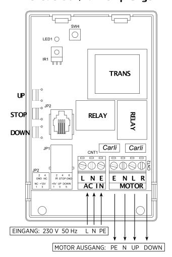
Funk-Fernbedienung & Motor-Steuergerät für Deckenlifte/Leinwände
